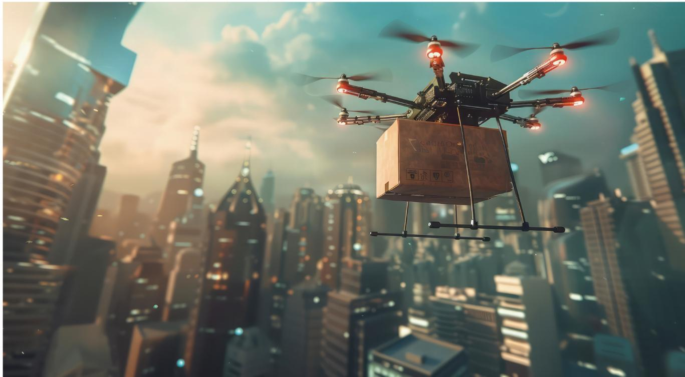
イームズロボティクスでは大型のマルチローター開発を進めています。「ラストワンマイル配送」を目指しており、個人宅を含めた短距離配送の実現を計画しています。この新型ドローンは、着陸せずに吊り下げ機構による荷下ろしを可能とします。そのため、従来のような着陸地点の必要はなく、狭い範囲での荷下ろしもできるようになります。
