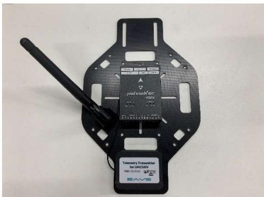
フライトコントローラーの TELEM1 と機体側のテレメトリーを付属の6ピンケーブルで接続
