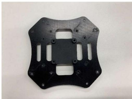
写真を参考にベルクロをアッパープレートに通して取り付ける
