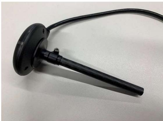
アッパープレートに GPS のアンテナの固定ベースを取り付ける
