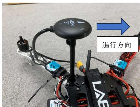
GPSケーブルをフライトコントローラーのGPS1に接続する(接続時にカチッと音をする)
