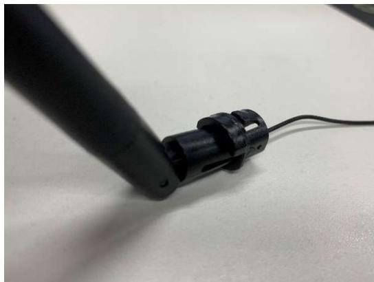
3Dプリンターのアンテナホルダーを取り付ける
