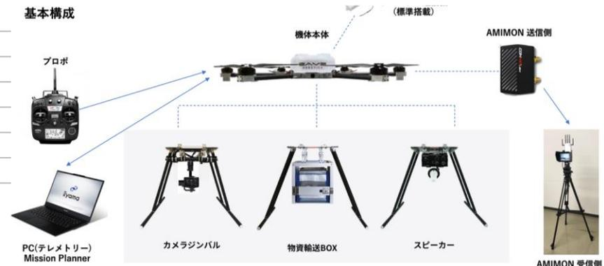
災害時用途、主に災害対策課が運用。災害発生時の状況確認および物資輸送が可能。下記3種類の脚部を脱着して切り替え可能。
