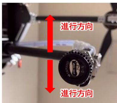
ノズルを取り付ける際は、写真のように吐出口が進行方向と同じになるように取り付けてください。
