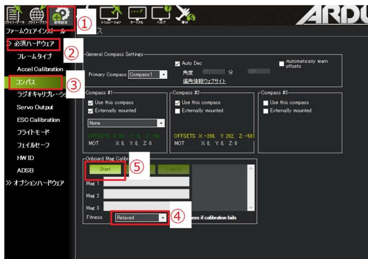
「Start」をクリックしたら、PixHawk mini を中心に回転させる。
